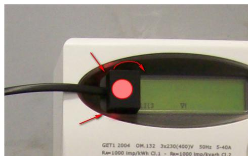
E' consigliato ancorare il cavo che esce dal lettore ottico in modo che questo non gravi direttamente sull'adesivo che sostiene il lettore stesso. Al termine applicare l'adesivo nero per oscurare l'ottica avendo l'accortezza di non nascondere la finestra di lettura del display.
